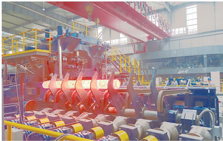
Φ258侧出式连轧管机生产线包含上百台机械设备,其中液压站、干油站和稀油站40余台,阀台70余个,电气控制柜300余台。技术人员在设计时进行系统性、全面性、科学性的规划,充分使用数字化设计手段、大量采用成熟的智能技术。由于项目工艺复杂、生产节奏很快,要求每个单元都能快速准确地完成
