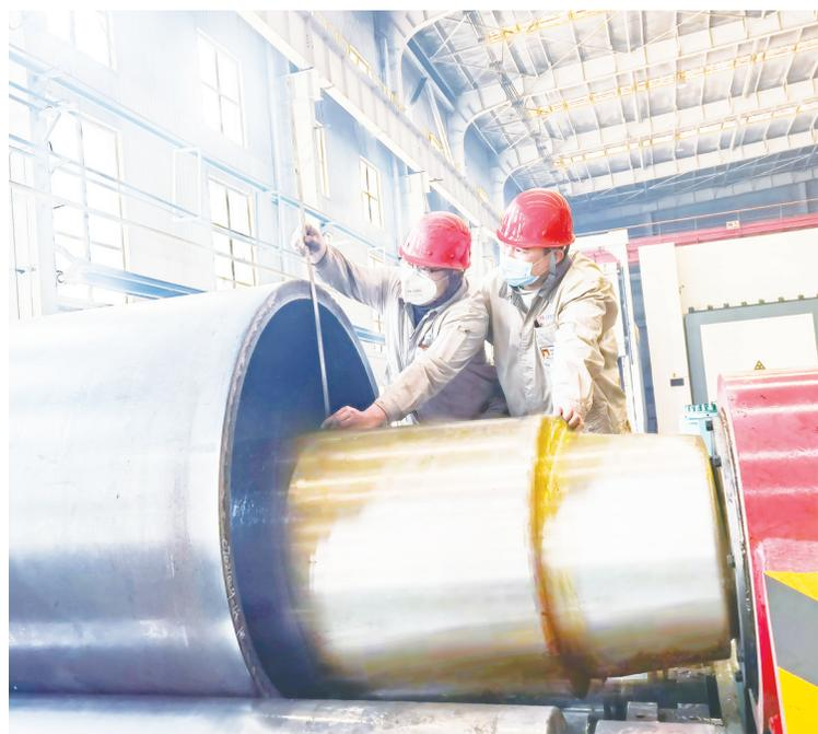
五月好时光,奋进正当时。核电分公司抢抓生产“黄金季”,充分挖掘自身潜力,全力以赴提质量、保急需、抓重点,有序组织各项生产任务。图为分公司备料工部工人师傅们正在对毛坯钢套进行圈制成型后的校圆,为确保筒体椭圆度达到工艺要求,操作人员反复确认尺寸,保证产品质量符合后续加工要求。
