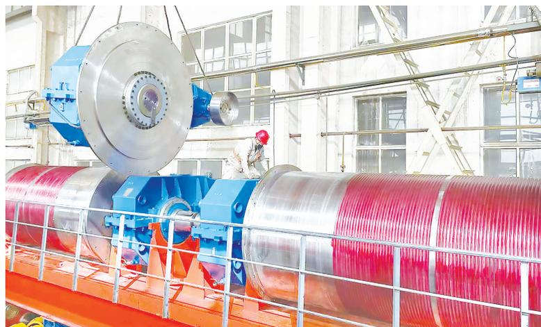
3月14日,在起重机分公司装配现场,装配工部职工正在对分公司重点产品铸造吊的起升机构进行装配作业。一季度,起重机分公司提前进行产能布局,充分挖掘自身潜力,全力以赴保急需、保重点,有序组织生产,确保重点产品交货期。
