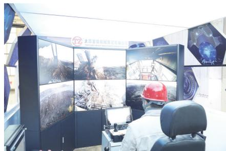
“能坐在办公室开挖掘机,这在以前是想都不敢想的事”。有着20多年驾龄的煤矿挖掘机司机王永胜坐在整洁舒适的5G远程操作室内,透过6个高清显示屏上360度传回的工作画面,轻松控制着一台千里之外的挖掘机作业。这是公司自主研发开发的远程智能操控矿用挖掘机。
